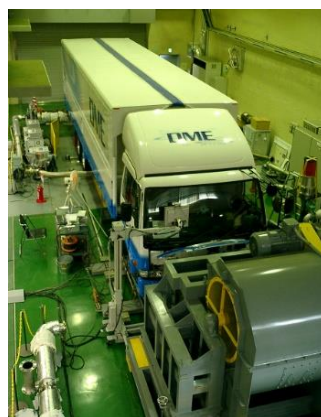
図4 重量車のシャシダイナモ試験の例 （車両は過去の次世代事業で開発したディーゼルメチルエーテル（DME）車）
